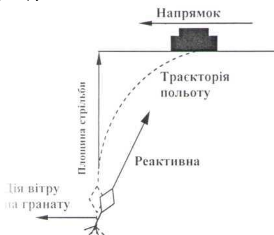
Мал. 13. Вплив бокового вітру на політ гранати при роботі реактивного двигуна
