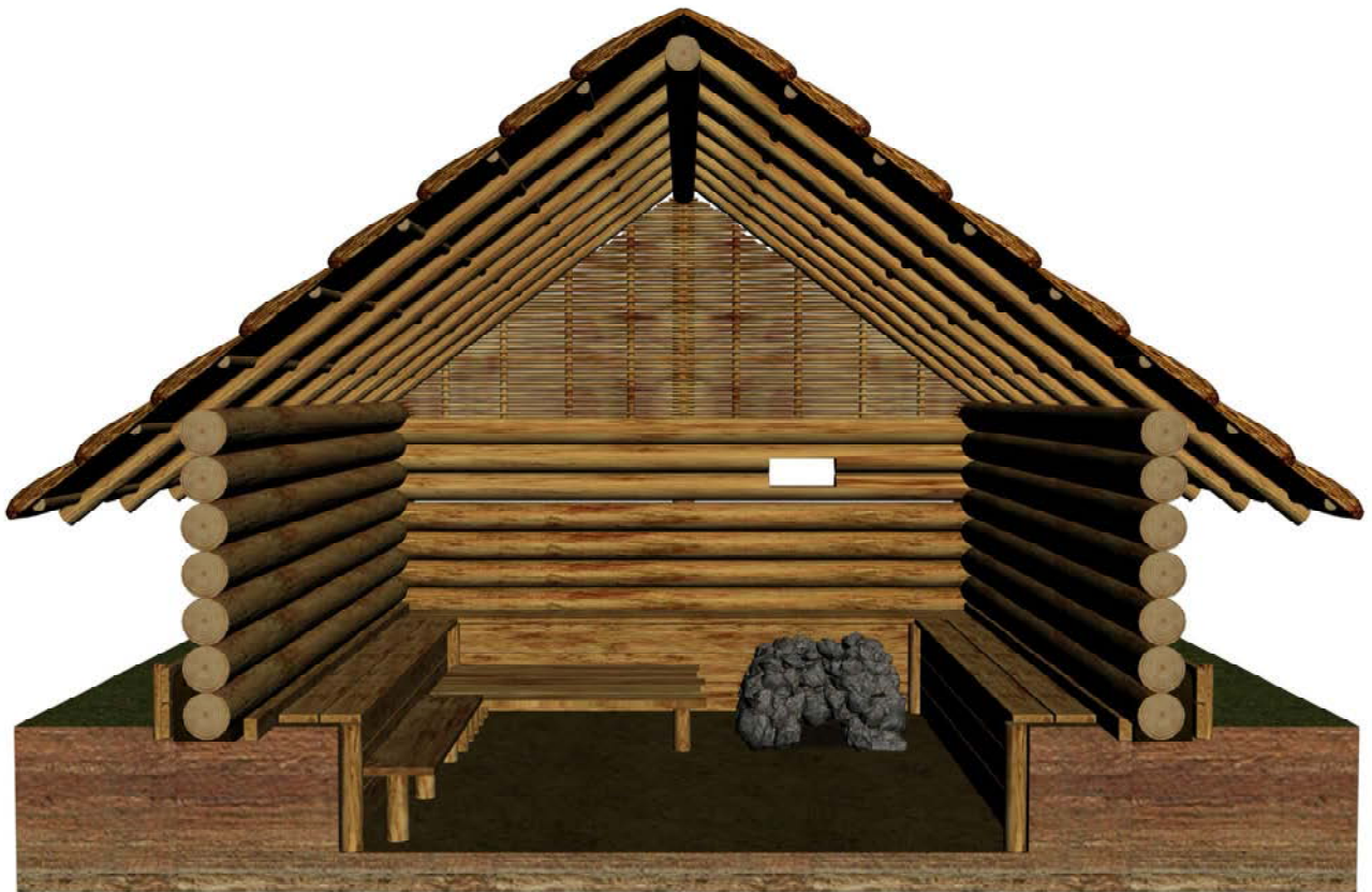
Рис. IV-65. Житло зі зрубною конструкцією стін за межами котловану і дахом на сохах, встановлених за межами котловану, та плетеним фронтоном. Реконструкція: Я. Погоральський, В. Федевич; комп'ютерна графіка (3D-Max): І. Мелимук, В. Федевич.
