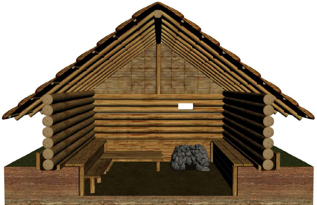
Рис. IV-64. Житло зі зрубною конструкцією стін за межами котловану і дахом на півсохах та плетеним фронтоном. Реконструкція: Я. Погоральський, В. Федевич; комп'ютерна графіка (3D-Max): І. Мелимук, В. Федевич.
