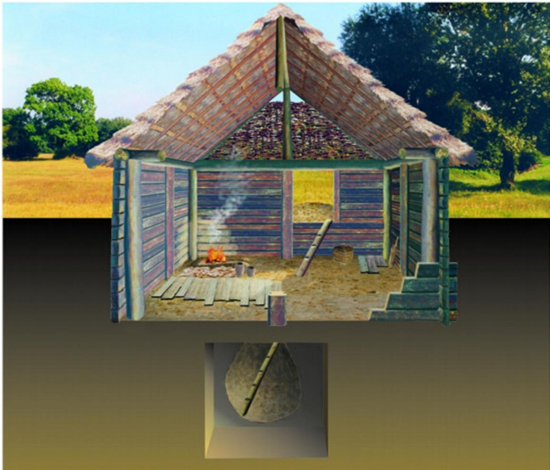
Рис. IV-16. Реконструкція житла зі змішаною конструкцією стін – поєднання каркасно-стовпової і зрубної технік із поселення Краків-Нова Гута-5В (Вицьонже) (за Poleska, Bober, 1996, рис. 13, 15).
