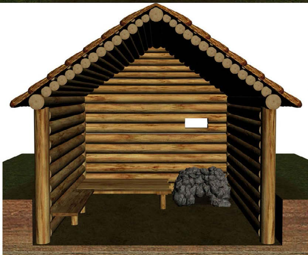
Рис. IV-61. Житло з каркасно-стовповою конструкцією стін в котловані і дахом «суцільним накотом». Реконструкція: Я. Погоральський, В. Федевич; комп'ютерна графіка (3D-Max): І. Мелимук, В. Федевич.
