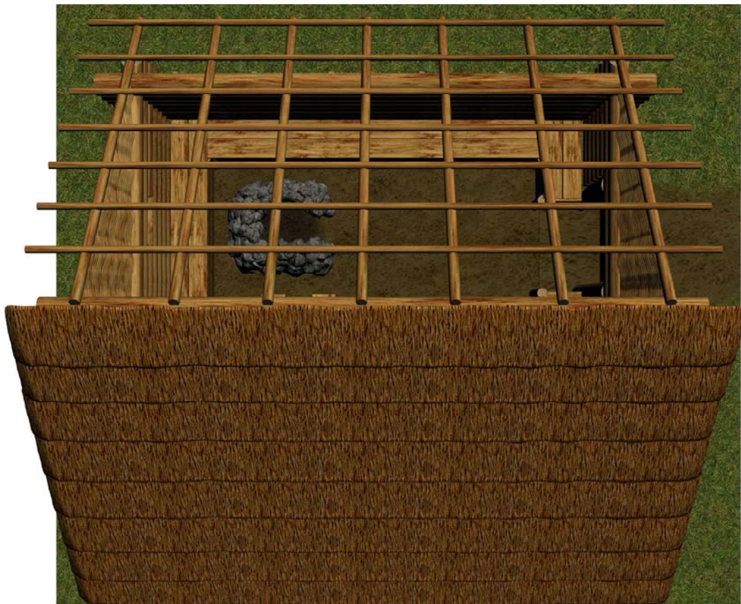
Рис. IV-66. Житло зі зрубною конструкцією стін за межами котловану, дахом на півсохах (з каркасом покриття – вид зверху) і стелею. Реконструкція: Я. Погоральський, В. Федевич; комп'ютерна графіка (3D-Max): І. Мелимук, В. Федевич.
