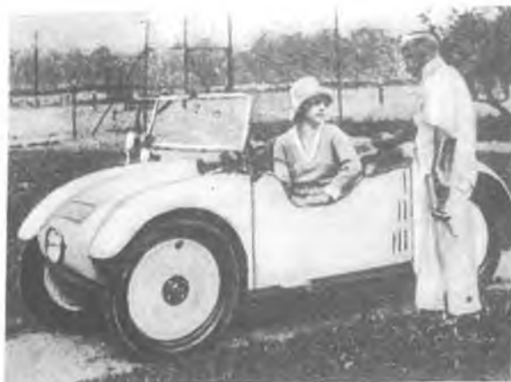
Перший малолітражний автомобіль «Ганомаг» на два місця. Мотор у нього був позаду.
