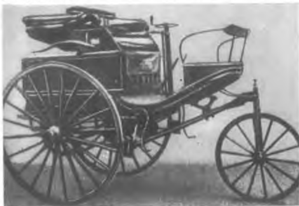
1888 рік. Німецький конструктор Бенц збудував цю модель. Колеса з неї дерев'яні, передача — ланцюгова. Мотор — одноциліндровий чотиритактний, потужністю 1,5 кінських сили при 250—300 обертах на хвилину.
