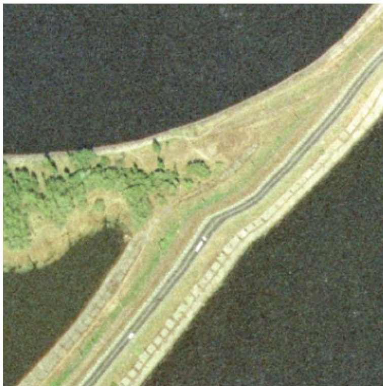
Деформація лінійних об'єктів на ортофотопланах.
