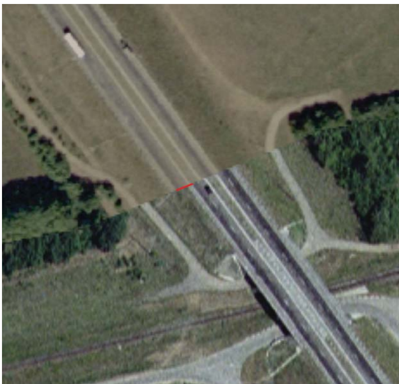
Зміщення ситуації ортофотоплану на 8,9м
