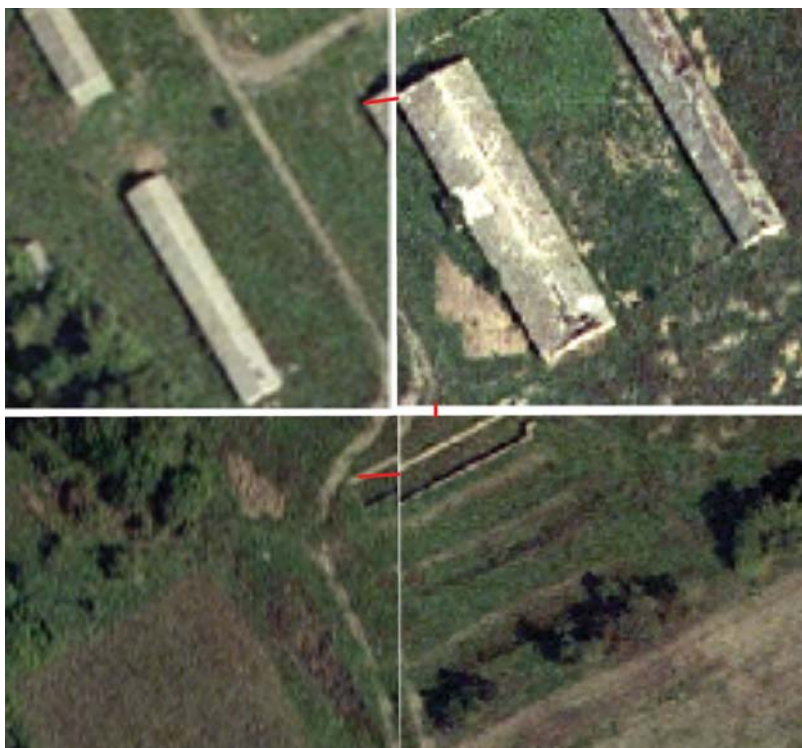
Зміщення ситуації на 9-10м на межі планшетів ортофотопланів
